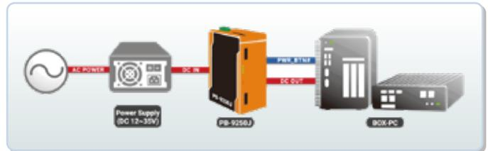
さまざまなモード、自動シャットダウン制御、および最大180Wの出力電力を特長とするPB-9250J-SAは、ほとんどの市販のボックスPCと連携できます。また、メンテナンスフリーのスーパーキャパシタや無停電電源装置などの特性により、過酷な産業環境での停電時に接続されたバックエンドシステムのデータ損失を防ぐことができます。
