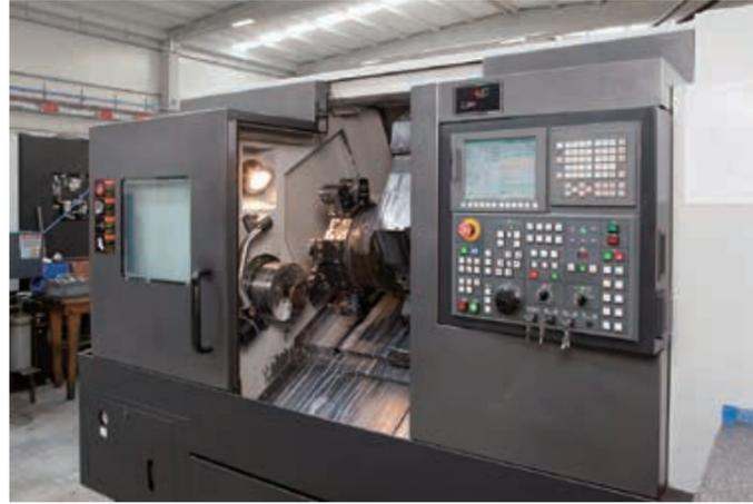
これらのIO-Linkスピンドルは、CNCマシン上で動作する切断ツールでComtrolのDR-8-EIP IO-Link Masterを使用してCNCコントローラに接続されます。カスタマは、IO-Linkを介してISDU (Indexed Service Data Unit) メッセージングを使用し、監視に値する特定のデータを読み取ることが可能であることを取得しました。機械製造メーカは、回路基板の温度と振動を含むスピンドルからデータを読み取ろうとしていました。また、スピンドルは、衝突検出およびメカニカルパーツのためのサイクルカウンタを含むデータも提供します。他の標準的な非IO-Linkスピンドルは、多くの場合、データや診断情報に多くのアクセスを提供することなく設計通りに実行します。しかし、IO-Linkバージョンを使用することにより、このパワフルな技術を利用してエンドユーザに“smart machine”を提供することができます。そしてComtrolのマスターを使用して、この情報をコントローラに伝えることができます。
