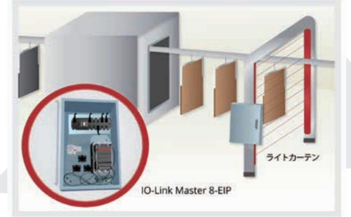
CML720i light curtainsは、ペイントパウダ塗装マシンの入り口に設置され、製品サイズに基づき移動に合わせてスプレイの開始および停止を自動化されたペイントガンにその情報を伝えます。このソリューション以前には、被塗装製品がペイントパウダ塗装マシンに到着する前にスプレイを始め、時間の経過とともに大量の塗料が浪費される状況でした。また、ユーザは、ペイントスプレイマシンを通して被塗装製品を運搬するコンベヤシステムに接続されたフックをスプレイすることを避けたいと考えました。このすべての情報は、ComtrolのIO-Link master 8-EIPを介してEtherNet/IP上で実行されているPLCに伝えられます。
